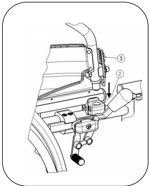
4. Verrouillez le tube avant de l'accoudoir dans le logement de tube ②.
