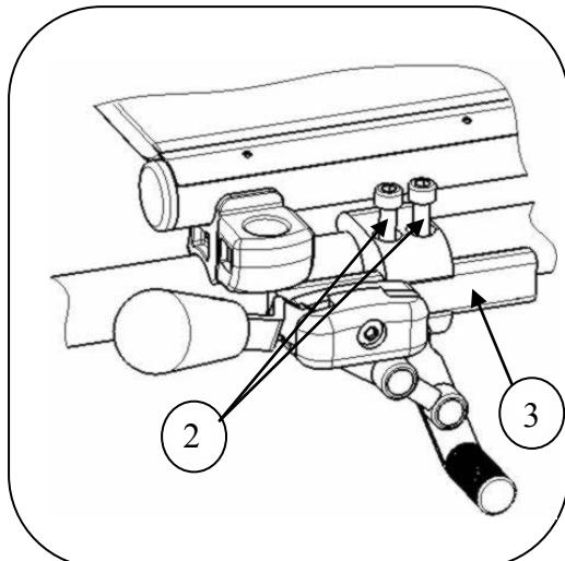
3. Afloje los tornillos ② para que el mecanismo del freno se deslice por la guía ③.
