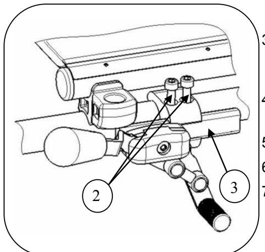
3. Desserrez les boulons ② pour que le mécanisme de freinage puisse glisser sur le guide ③.
