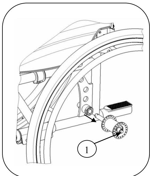
Per agevolare il trasporto della carrozzina, è possibile rimuovere le ruote posteriori:
