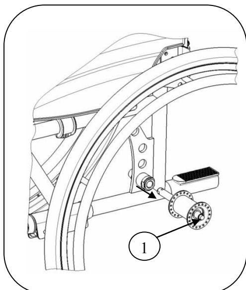
Les roues arrière peuvent être retirées pour faciliter le transport du fauteuil roulant :
