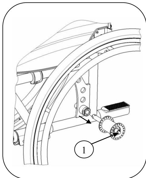
Für eine einfacheren Transport des Rollstuhls können die Hinterräder abgenommen werden:
