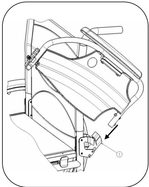
1. Montare il tubo posteriore del bracciolo sul coperchio del tubo ①.
