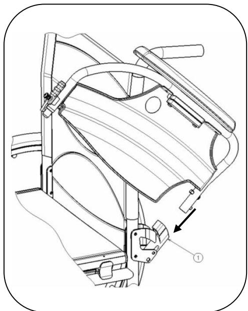
1. Montez le tube arrière de l'accoudoir dans le logement de tube ①.
