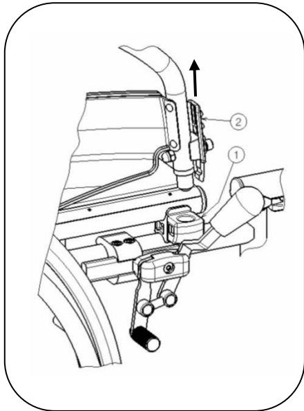
1. Drücken Sie den Hebel ② und ziehen Sie die Vorderseite der Armauflage nach oben.
