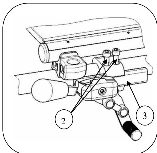
3. Lösen Sie die Schrauben ②, so dass der Bremsmechanismus über die Führung ③ geschoben werden kann.
