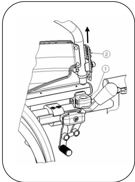
1. Presione la palanca ② y tire de la parte delantera del reposabrazos hacia arriba.
