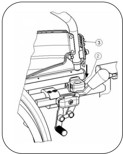
4. Schieben Sie das vordere Rohr der Armauflage in die Rohraufnahme ②.
