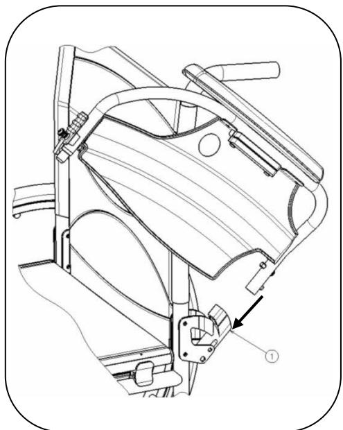
1. Schieben Sie das hintere Rohr der Armauflage in die Rohraufnahme ①.
